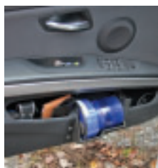
Mocowanie lampy błyskowej w drzwiach nieoznakowanego radiowozu
