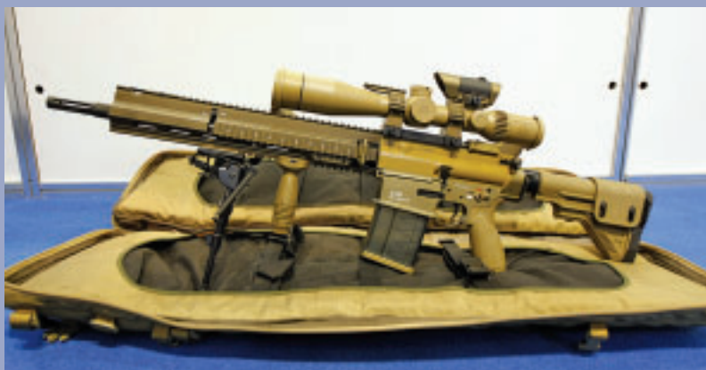
Samopowtarzalny karabin wyborowy z laserowym celownikiem. Trafia w cel z odległości 1000 m
