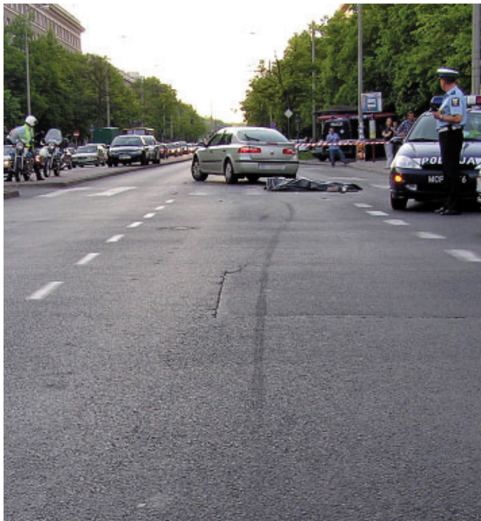
Samochód wykonuje manewr zawracania i zderza się z motocyklem. Widać ślad hamowania w kształcie wydłużonej litery s
