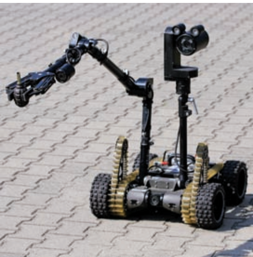
Robot PIAP Scout przenosi niewybuch granatu F-1 do miejsca neutralizacji
