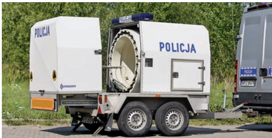
Przyczepa pirotechniczna Dynasafe ze sferycznym gazoszczelnym pojemnikiem przeciwybuchowym. Można w nim przewozić do 5 kg materiałów wybuchowych. Takie przyczepy powinny mieć wszystkie komórki minersko-pirotechniczne, a mają tylko w Warszawie i Krakowie. Niestety są drogie. Kosztują około 1 500 000 zł
