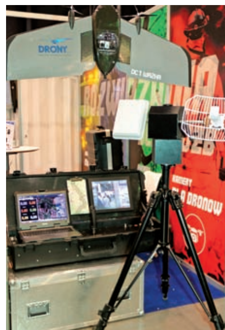
Dron DC 1 Ważka. Waży 1,6 kg, lata z maksymalną prędkością 20 m/s. Może być wyposażony w trzosiową głowicę obserwacyjną z kamerą lub termowizją
