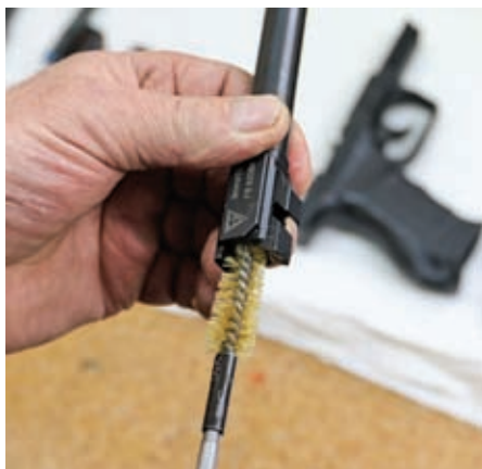
9 mm pistolet Walther P99 – czyszczenie lufy
