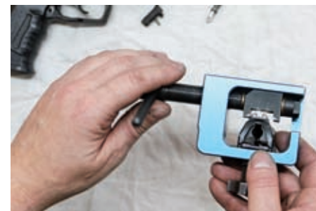
9 mm pistolet Walther P99 – regulacja celownika
