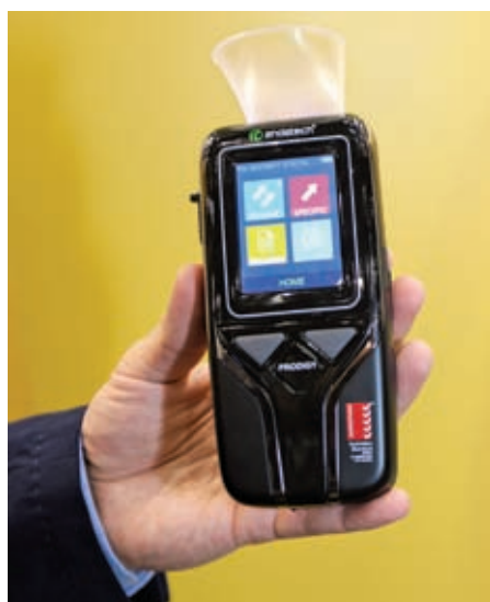
Alkomat Prodigy S. Wyniki badań wyświetlane są na ekranie LCD. Pamięć urządzenia umożliwia zapis do 10 tysięcy pomiarów m.in. z danymi osób badanych i przeprowadzających pomiary oraz czasami ich wykonania. Bada z dokładnością \pm 0,005\% . Urządzenie ma również tryb do pomiarów przesiewowych, który umożliwia sprawdzenie wielu osób w krótkim czasie
