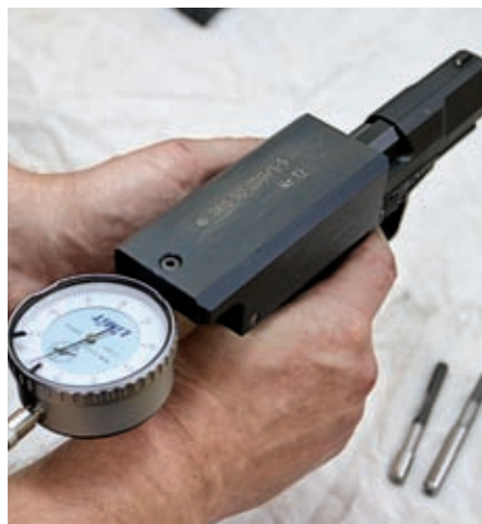
9 mm pistolet Walther P99 – kontrola drogi iglicy przy napinaniu spustu
