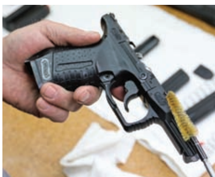
9 mm pistolet Walther P99 – nakładanie niewielkiej ilości oleju na prowadnicę zamka
