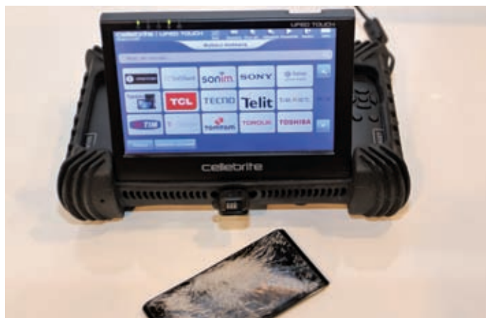
Urządzenie do odczytu danych z uszkodzonych smartfonów i tabletek. Można przy jego użyciu odzyskać m.in. numery telefonów, zdjęcia, pliki dźwiękowe i wideo
