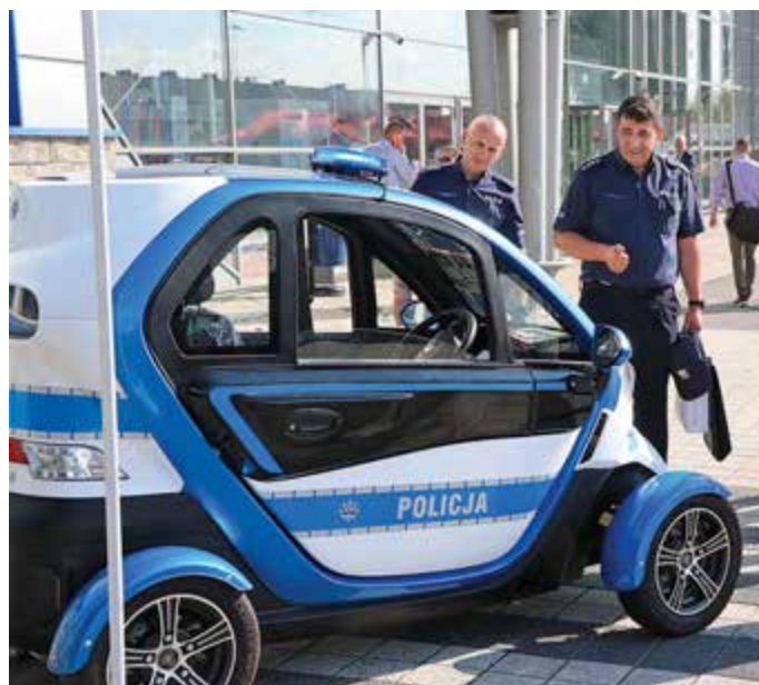
Dwuosobowy radiowóz elektryczny 4K o mocy 3kW i zasięgu 80 km
