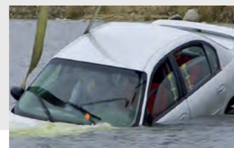
Grafika 2. Pojazd, który wpadnie do głębszej wody dachem do dołu (kołami do góry), jeżeli ma nienaruszone oraz zamknięte szyby, to po około 28-37 sekundach zacznie się obracać do pozycji neutralnej (dachem do góry, kołami do dołu). Sam obrót trwa 5-6 sekund [4].
