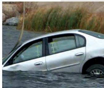
Grafika 1. Pojazd wpada do wody pod dużym kątem (około 60°). Następnie po kilku sekundach opada do pozycji poziomej [4].
