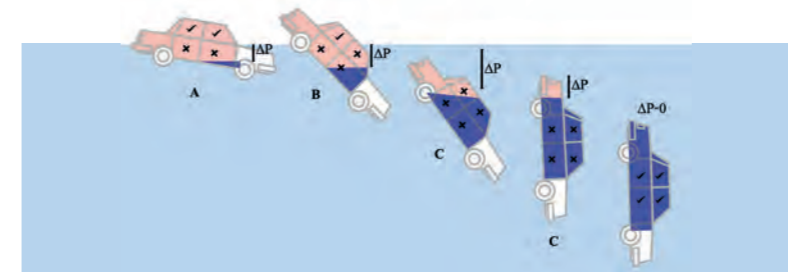
Grafika 4 przedstawia trzy fazy tonięcia pojazdu: A – faza unoszenia (floating) – otwarcie drzwi trudne lub niemożliwe – otwarcie lub wybite szyb bocznych możliwe; B – faza tonięcia (sinking) – otwarcie drzwi niemożliwe – otwarcie lub wybite bocznych szyb trudne lub niemożliwe; C – faza zanurzenia (submersion) – otwarcie drzwi możliwe po tym, jak całe powietrze wydostanie się z pojazdu – otwarcie lub wybite bocznych szyb możliwe, po tym jak całe powietrze wydostanie się z pojazdu. Kieszka powietrzna obejmuje całe wnętrze pojazdu. \Delta P = różnica ciśnienia (poziom wody na zewnątrz – wewnątrz). Gdy pojazd jest pod wodą, różnica ciśnienia nadal istnieje. \Delta P = 0 dopiero wówczas, gdy całe powietrze wydostanie się z bagażnika [4].
