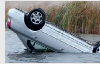
Grafika 3. Gdy samochód ląduje w płytkiej wodzie odwrócony (dachem do dołu, kołami do góry), to nie ma możliwości obrotu, ponieważ przód pojazdu (maska) styka się z dnem. W tej sytuacji pojazd zatoni dachem do dołu [4].
