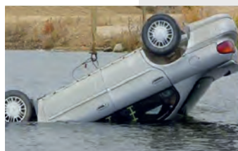
Grafika 2. Pojazd, który wpadnie do głębszej wody dachem do dołu (kołami do góry), jeżeli ma nienaruszone oraz zamknięte szyby, to po około 28-37 sekundach zacznie się obracać do pozycji neutralnej (dachem do góry, kołami do dołu). Sam obrót trwa 5-6 sekund [4].
