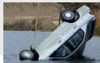
Grafika 2. Pojazd, który wpadnie do głębszej wody dachem do dołu (kołami do góry), jeżeli ma nienaruszone oraz zamknięte szyby, to po około 28-37 sekundach zacznie się obracać do pozycji neutralnej (dachem do góry, kołami do dołu). Sam obrót trwa 5-6 sekund [4].
