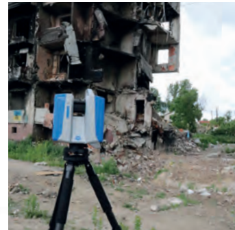
Skaner 3D Z+F Imager 5016 rejestruje zniszczenia na Ukrainie
