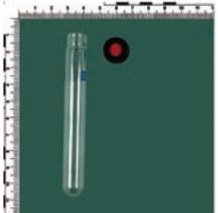
Fiolka i korek. Wnętrze korka (czerwone) z półprzepuszczalnego tworzywa
