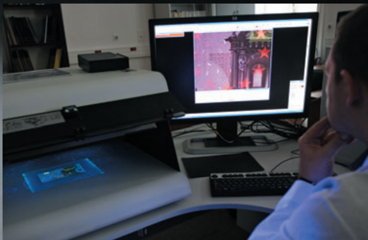
Video spectral comparator VSC6000 do obserwowania banknotów w różnych zakresach promieniowania
