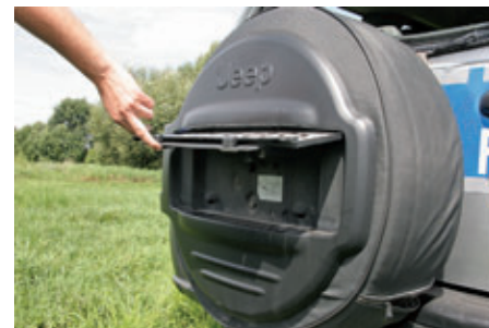
Sposób na zdjęcie koła zapasowego
